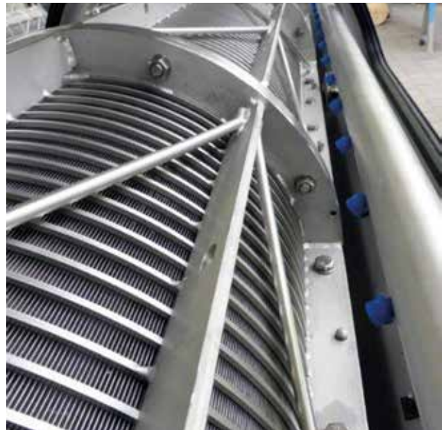
Giỏ thanh nệm chắc chắn được làm bằng thép không gỉ.
