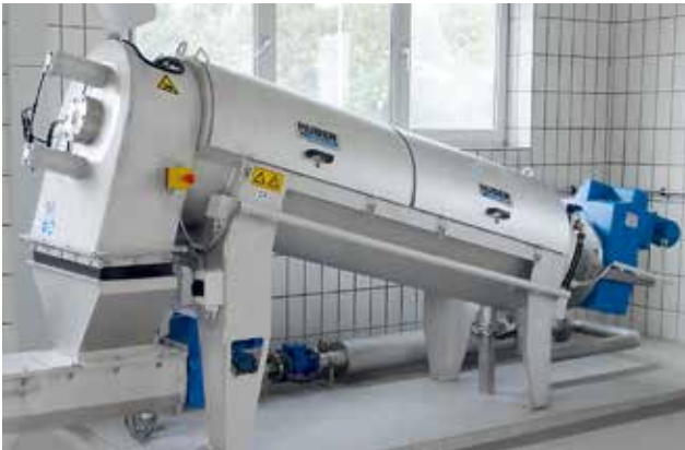
Q-PRESS® 440.2 được gắn cố định với tốc độ 3 m 3 /h.
