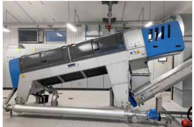
Bùn phân hủy được khử nước lên đến 30% DR.
